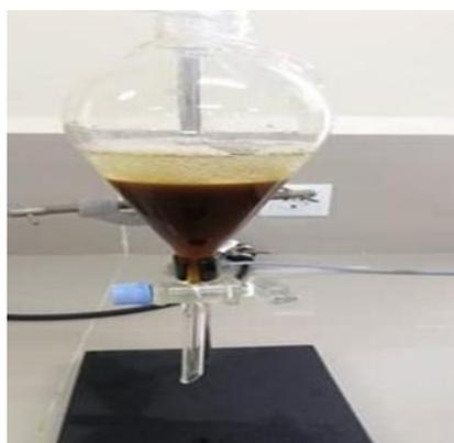
**Figure 16** : La décantation d'un mélange hystérogène (photo originale)
