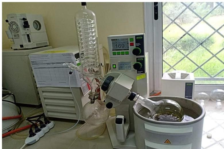
**Figure 15** : Evaporation du filtrat (photo originale)
